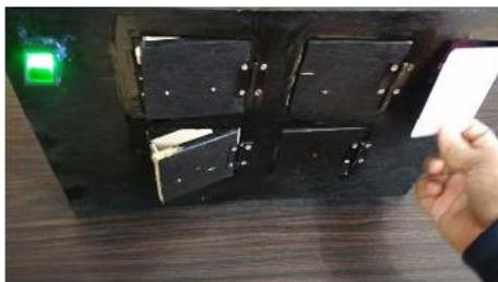
Gambar 6. Proses Scan Kartu RFID Berhasil Membuka Loker
